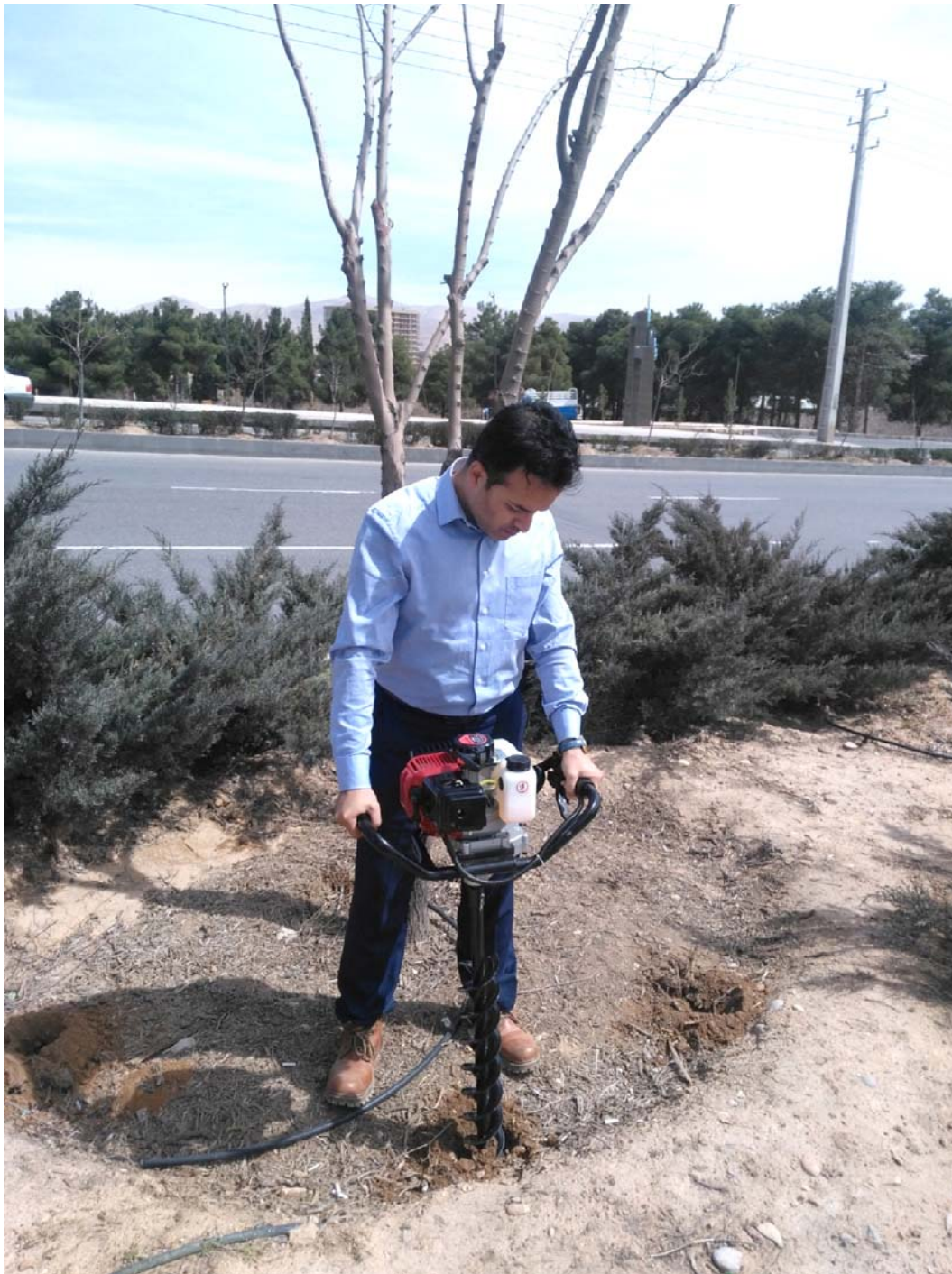
شکل ۴. عملیات مته زنی توسط مته دستی بنزینی
